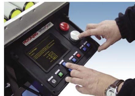
Interfaz hombre-máquina (HMI) sencilla con diseño intuitivo
